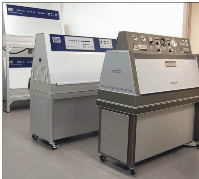
Tres generaciones de Cámaras de envejecimiento acelerado QUV incluyen (empezando por la derecha) una cámara clásica de cubierta marrón con controles electromecánicos, una cámara QUV de la década de 1990 con cubierta azul y control de irradiación Solar Eye y dos cámaras QUV actuales montadas en el Bastidores de tamaño reducido.
